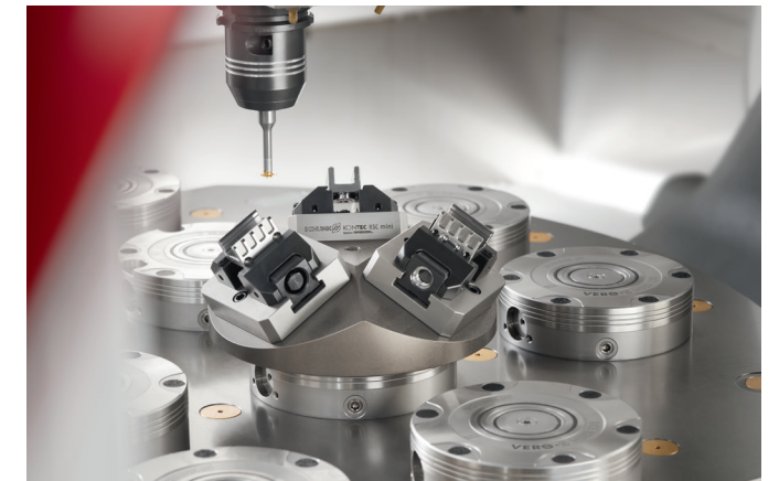
Einbringung von Nuten mit dem TENDO E compact
