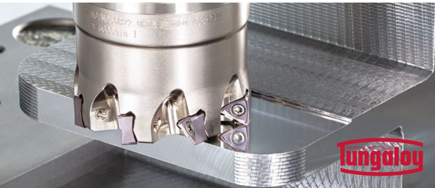
TNMU07-MJ mit integrierter Wiper-Schneide APMX = 6,5 mm
